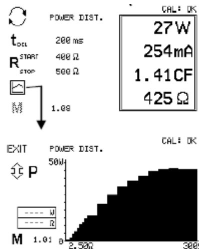
Acquisition automatique d'une courbe de caractéristiques de charge
