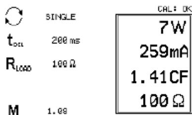
Mesure simple avec enregistrement des données, courant, Coefficient de Crête et charge.
