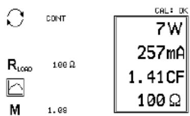
Affichage en continu des données, (courant, puissance, coefficient de crête, charge), pour ajustement.
